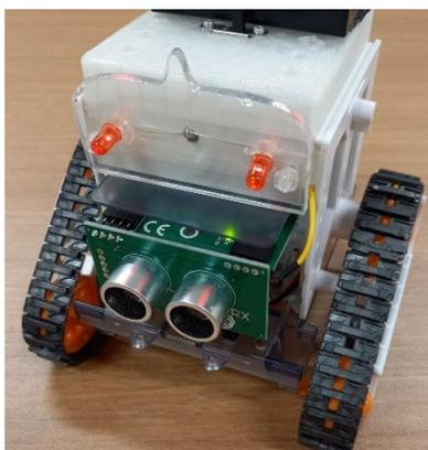
図8 ロボット本体に取り付けたレーザー加工機で彫刻を施したロボット用の装飾
