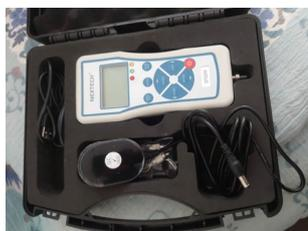
図 9 力測定装置の外観
