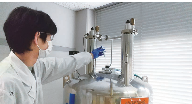
▼NMRによる新しい有機化合物の構造解析
