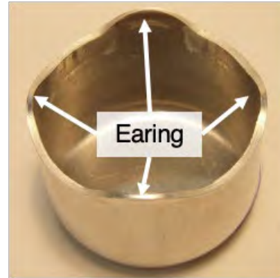
図 1 円筒深絞り加工で生じる「耳」
