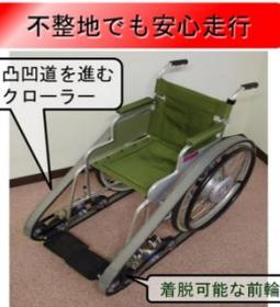
凸凹道を進むクローラー, 着脱可能な前輪
