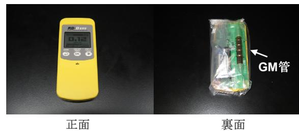
図3 GM計数管式サーベイメータ(株式会社ダブリュービーエス:RD-II)
