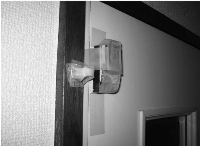
図 4 被験者 A 宅の扉に設置した開閉センサ
