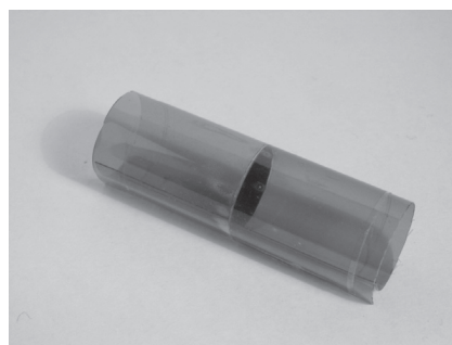
Fig.5 完成した偏光シート筒の外観
