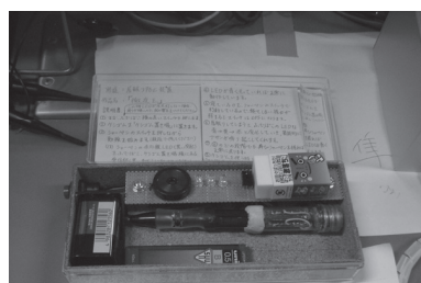
図7 勉強していて眠くなると警告音を出す装置。ペンを握る力が緩むとIR通信で筆箱にあるアラームに信号が送られる。ペンの中に回路を組み込む工作に大変苦労した。
