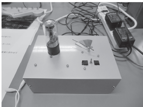
図11 マジックアイとステップモータを用いたオーディオレベルメーター。ステップモータをレベルメーター表示に使うところが面白い。コミカルな動きをする。
